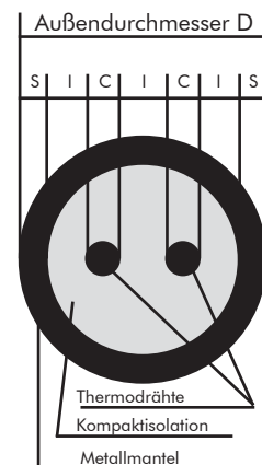
Querschnitt der Mantelleitung gemäß DIN EN 61 515
