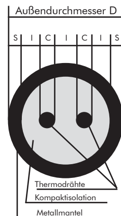
Querschnitt der Mantelleitung gemäß DIN EN 61 515
